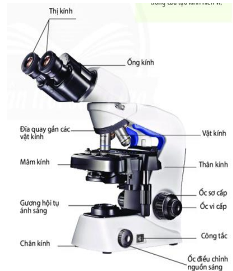
▲ Hình 3.8. Cấu tạo kính hiển vi quang học
